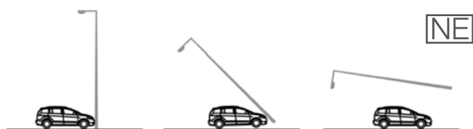
Mast der flyver over bilen. Kilde: Håndbogen for eftergivelige master, marts 2021
